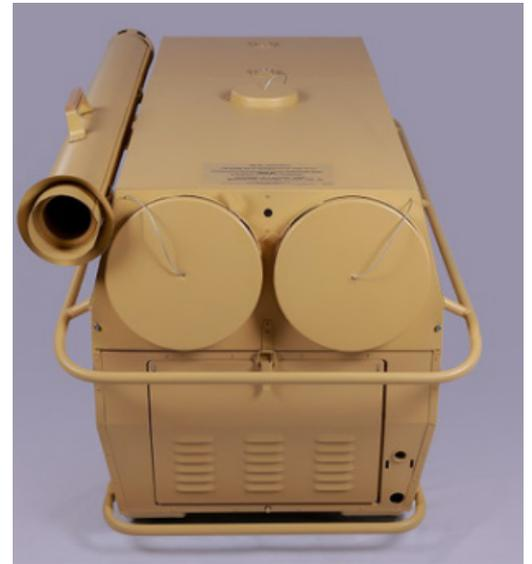
Обогреватель дизельный ОД-38 был разработан для нужд Министерства обороны Российской Федерации. Теплогенератор отличает пониженный уровень шума, полностью автоматическое отключение и включение обогревателя для поддержания заданной температуры, экономичный расход топлива, автоматический контроль пламени горелки, контроль содержания углекислого газа, защита от перегрева. Запуск отопителя происходит по одному нажатию кнопки даже при  $-50^{\circ}\text{C}$ .
