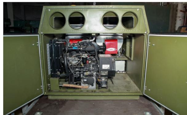
Мобильный подогреватель воздуха оснащен шасси МЗСА 852111, которое имеет свое прицепное устройство и тормозную систему, что обеспечивает мобильность подогревателя.
